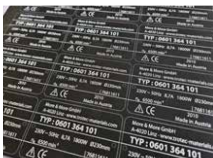
Produire des plaques signalétiques en marquant directement les métaux
