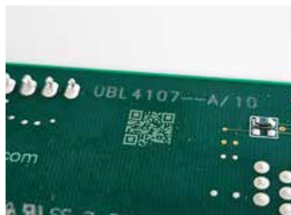
Coloque códigos QR perfectamente legibles en placas de circuitos impresos
