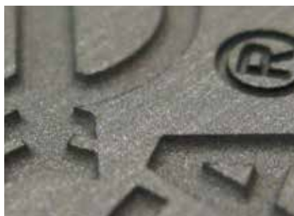
Głębokie grawerowanie metali
