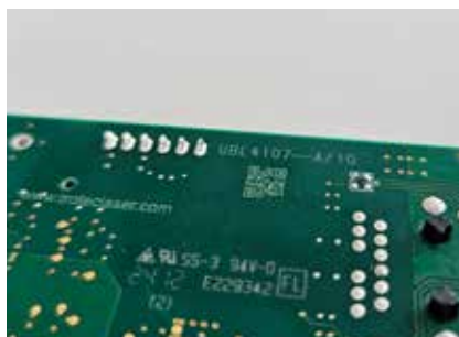
Najmniejsze rozmiary czcionki na płytkach drukowanych
