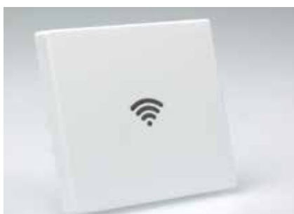
Marquage de plastique à haut contraste avec le laser MOPA
