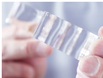
Découpe poli à la flamme - découpe jusqu'à 40 mm
