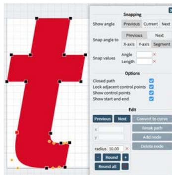
L'outil Édition des nœuds permet de déplacer, d'ajouter ou de supprimer des nœuds pour effectuer des ajustements précis. Le widget Édition des nœuds s'ouvre automatiquement après le modèle ou la sélection d'un objet vectoriel.
