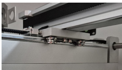
Detalj: styrrulle med lager och skenor, Y-axeln till vänster
