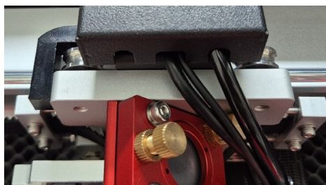
Detalj: styrrulle med lager och skenor, bearbetningshuvud
