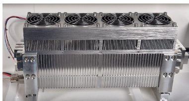
Laserkällans fläkt och ventilationsgaller
