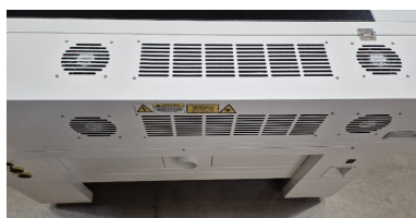
Ventilationsgaller i locket till laserkällan (stängt)
