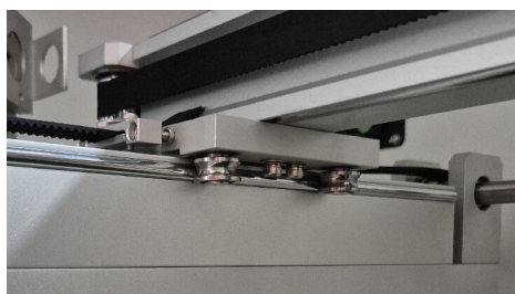
Detail geleidingsrol met lager en rails, Y-as links
