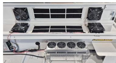
Ventilatioerooster in het deksel van de laserbron (open)
