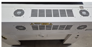
レーザー光源カバー内の換気グリル（閉じた状態）
