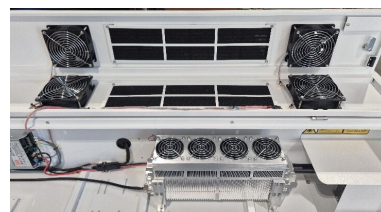
レーザー光源カバー内の換気グリル（開いた状態）
