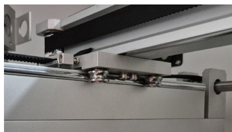
Y軸のガイドローラー（ベアリング付き） およびレール拡大図（左）
