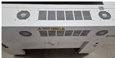
Griglia di ventilazione nella copertura della sorgente laser (chiusa)
