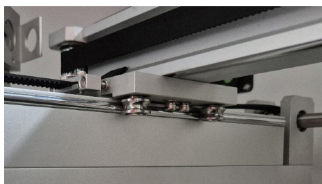
Dettaglio rullo di guida con cuscinetto e guide asse Y a sinistra
