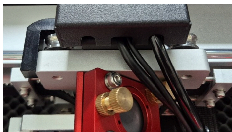
Dettaglio rullo di guida con cuscinetto e guide della testa di lavoro
