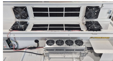
Grille d'aération dans le couvercle de la source laser (ouverte)
