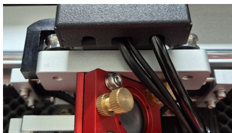
Detalle de la guía con rodamiento y rieles del cabezal láser
