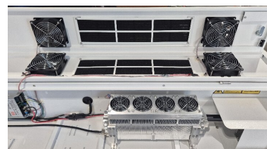
Rejilla de ventilación en la cubierta de la fuente láser (abierta)
