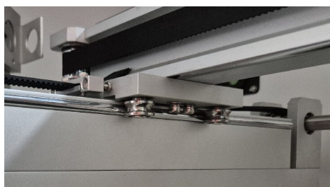
Detalle de la guía con rodamiento y rieles del eje Y, izquierda
