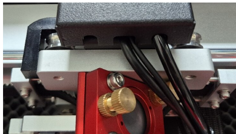
Detail Führungsrolle mit Lager und Schienen Bearbeitungskopf
