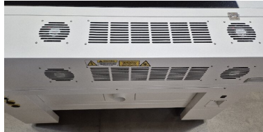
Lüftungsgitter in der Abdeckung der Laserquelle (geschlossen)
