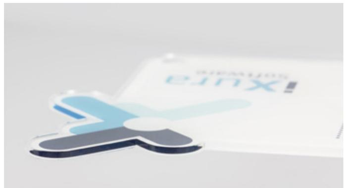
El corte láser produce bordes de corte muy pulidos
