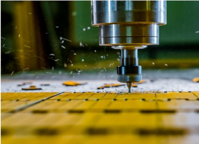
En el proceso de grabado mecánico, una fresadora se mueve sobre la superficie de la pieza previamente sujeta. El movimiento giratorio de la fresadora elimina el material de la superficie. Las fuerzas mecánicas actúan sobre la pieza.
