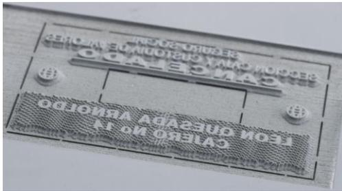
Sie möchten eine ganze Platte mit Stempelmotiven gravieren? Dann nutzen Sie die Funktion „Stege“ in JobControl®. Es werden automatisch kleine Verbindungsbrücken zwischen dem Stempelmotiv und der gesamten Stempelplatte hergestellt. Sie können dann die einzelnen Teile leicht aus der gesamten Platte herausbrechen, ohne dass die anderen Teile verloren gehen.
