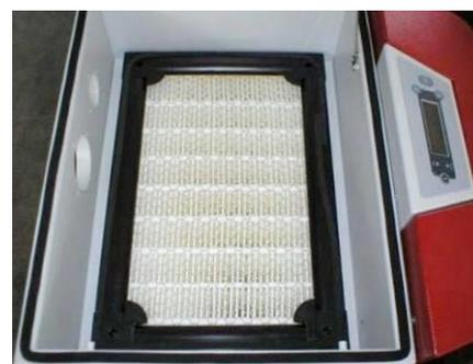
9. 清掃済みまたは新品の木ヤニフィルター／プレフィルターの四隅をフィルターカートリッジのパッキンの下に入れて、カートリッジの上に載せます。その上に新しいロールフィルターをフィルターカートリッジの上に被せるように置きます。
