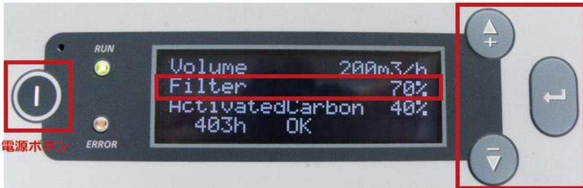
※Filter の数値は、装置内の気圧センサーが空気の流れをモニタリングしています。Filter が 100%になると、エラーランプが点灯し、ブザー音が鳴ります。
