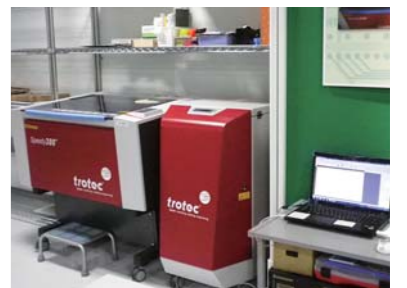
トロテック・レーザー加工機と集塵脱臭装置
