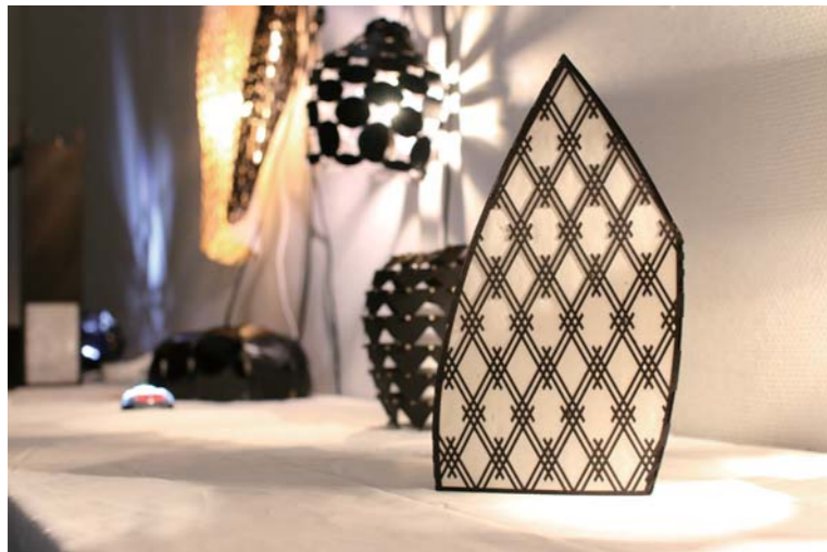
乾漆シートをレーザーカッターでカットして製作したランプシェード（照明）
