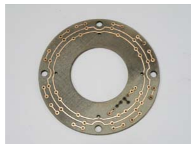
ファイバーレーザーで銅箔を剥がした LED アレー
