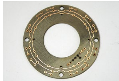
ファイバーレーザーで銅箔を剥がしたLEDアレー
