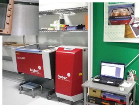
ワークショップコーナーに設置されているトロテックのレーザー加工機と集塵脱臭装置
