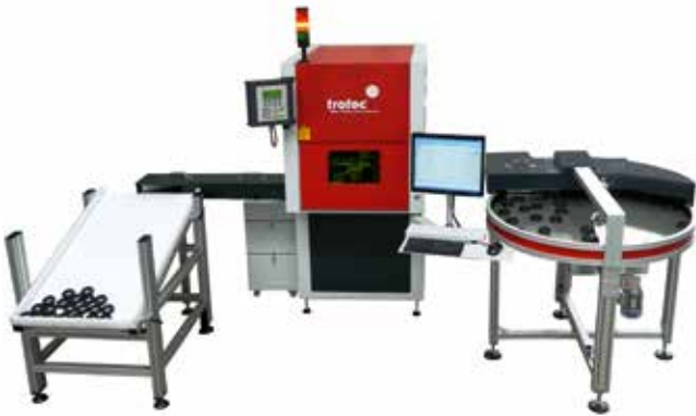
Anlage zur Kugellagerbeschriftung mit Vereinzlung und Sammelbehälter
