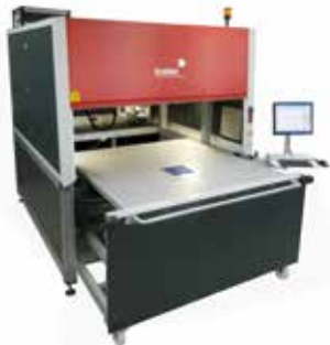
Teilehandlung mit Beladewagen zur Laserbeschriftung von übergroßen und schweren Teilen
