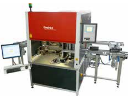
Markierung von Pinzetten in Lasermarkieranlage mit Bandumlaufsystem
