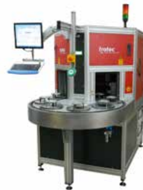
Deckelbeschriftung mittels Rundtaktanlage
