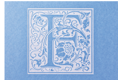
Acabado del papel mediante grabado por láser
