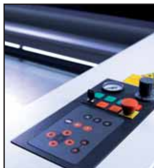
Panneau de commande avec système d'arrêt d'urgence et réglage de l'assistance de gaz
