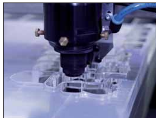
Exemple de découpe : PMMA : 30 mm d'épaisseur
