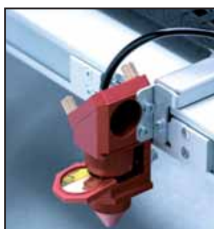
Changement rapide et simple de la lentille
