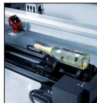
Gravure sur verre et objets cylindriques : Tourne-cylindre
