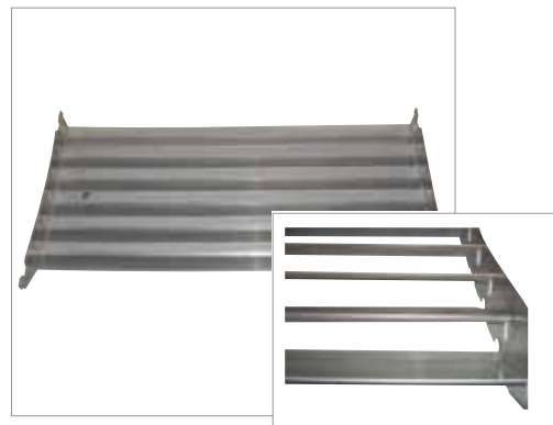
Plateau incurvé positionné sous le plateau à lames : les pièces tombantes sont ainsi à l'abri du laser
